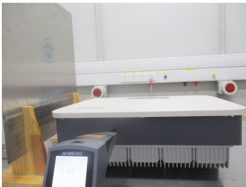
静电放电试验布置图
